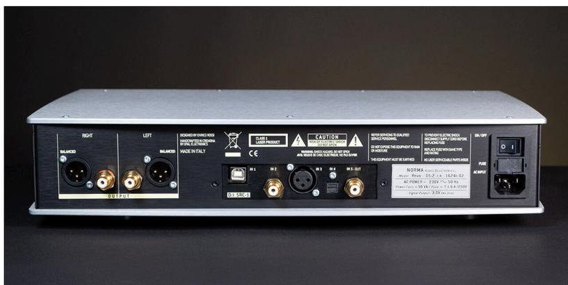
Das rückseitige Anschlussfeld des Revo DS-2 – der Norma besitzt fünf Digitaleingänge, USB-B und AES/EBU sind mit von der Partie
