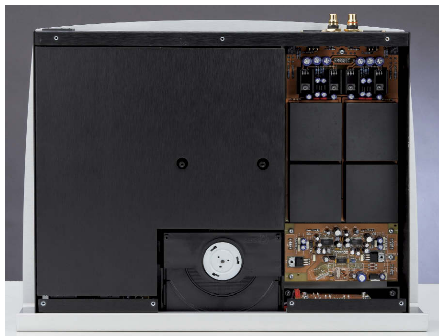
Limitandosi a togliere il coperchio superiore del lettore CD risultano visibili solo i componenti della sezione di conversione D/A (a ridosso del pannello frontale) e i regolatori di tensione dell'alimentazione (a ridosso del pannello posteriore). L'ampio coperchio metallico che occupa la parte sinistra e centrale dell'apparecchio copre invece gli altri componenti della sezione di alimentazione (tra cui il trasformatore toroidale e i condensatori elettrolitici di filtraggio) e parte della meccanica. I quattro piccoli coperchi metallici quadrati visibili sulla destra coprono invece i componenti degli stadi analogici di uscita, nei quali viene effettuata la conversione corrente/tensione a valle dei convertitori D/A.
