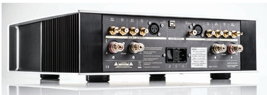
Topologia dual mono znajduje swoje odbicie na tylnej ścianie - kanały są rozdzielone. Użytkownicy gramofonów z podłączonym na stałe interkonektem, którzy skorzystają z opcji phono, nie będą zachwyceni, bo gniazda lewego i prawego kanału zajmują skrajne pozycje.
